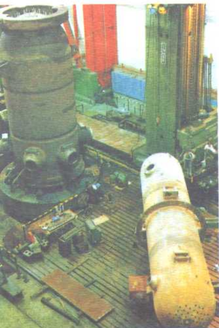
Vasija de reactor para centrales PWR cuyo peso es de 400 toneladas
